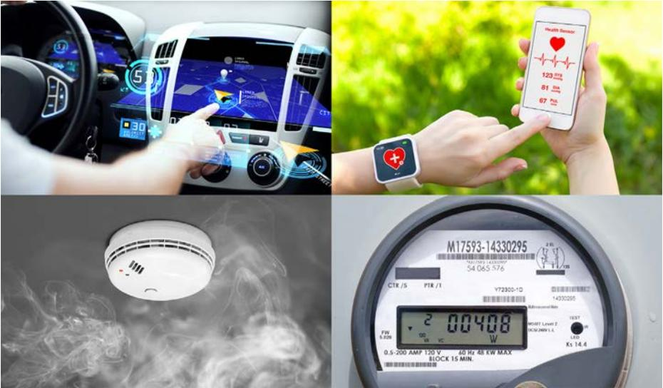
*Das Internet der Dinge in Beispielen: 1) Selbstfahrendes Auto, 2) Armband, das Gesundheitsdaten per Bluetooth zum Smartphone funkt, 3) „Intelligenter“ Stromzähler, der sekundlich per Mobilfunk den Verbrauch meldet, 4) Funkrauchmelder (WLAN-basiert)*
